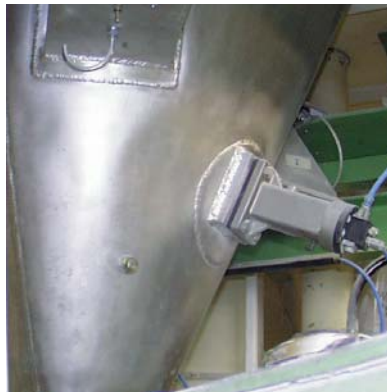
Abreinigen von Bunkerwänden
